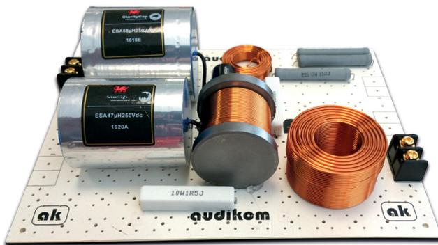
La seconda sezione, a cui diamo l'appellativo di "equalizzazione", formata dalla bobinetta da 0,05mH il cui compito è quello di equalizzare la risposta del tweeter in una gamma di frequenze fra 6kHz e 15kHz e la cella serie in parallelo al segnale sintonizzata circa alla frequenza di risonanza del tweeter al fine di agevolare il compito della prima sezione del filtro.
